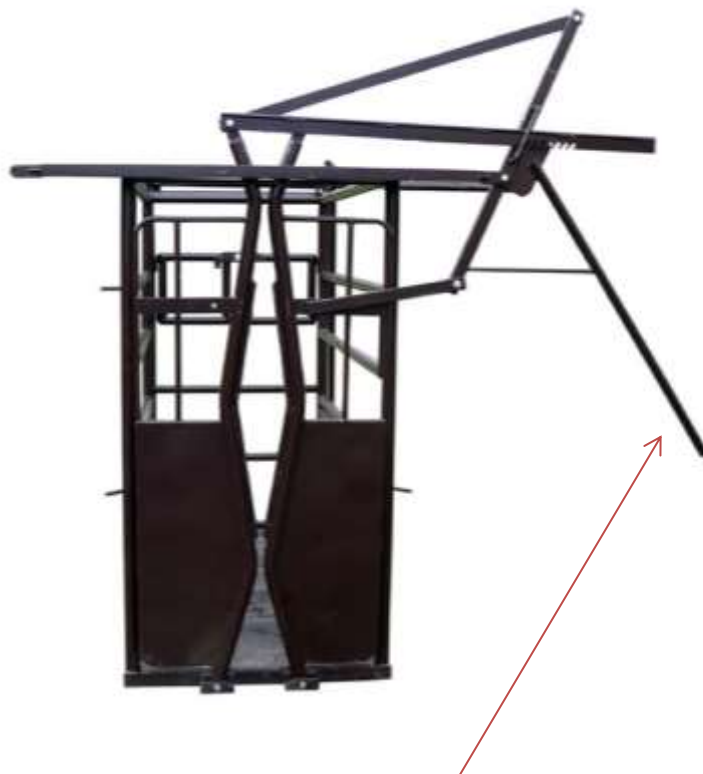
v přední části je krční fixační zařízení, rovněž přednastavitelné pro pravou i levou stranu
